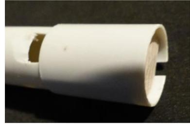
Das Holzstück wird mit der abgeflachten Seite nach oben in das Rohr eingesetzt und darf nicht bis zum Nutende reichen. Die Nut befindet sich ebenfalls oben. Es muss noch Platz zwischen dem Holz und dem Nutende für die Luft sein, die nach oben und nach unten Platz braucht.
